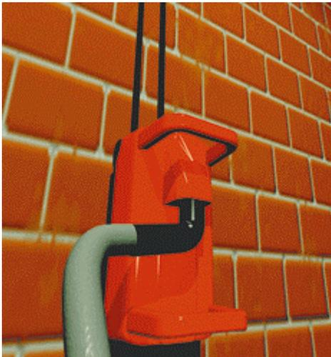
*Fig. 41 - Scanalatrice con aspirazione delle polveri, per la esecuzione delle tracce per gli impianti.*
