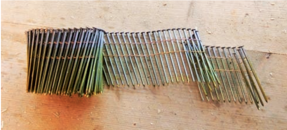
Figura 1.18. Chiodi a gambo liscio per sparatrice automatica
