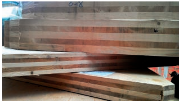
Figura 1.9 Pannelli di XLAM di vario spessore a 5 strati
