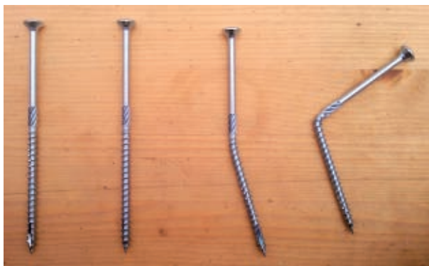
Figura 1.13 Viti autofiletteanti – plasticità
